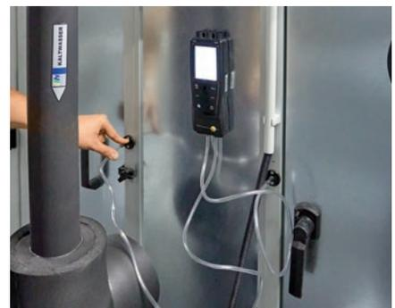
**Hochpräzise:** Ermittlung des Differenzdruck im Reinraum.
