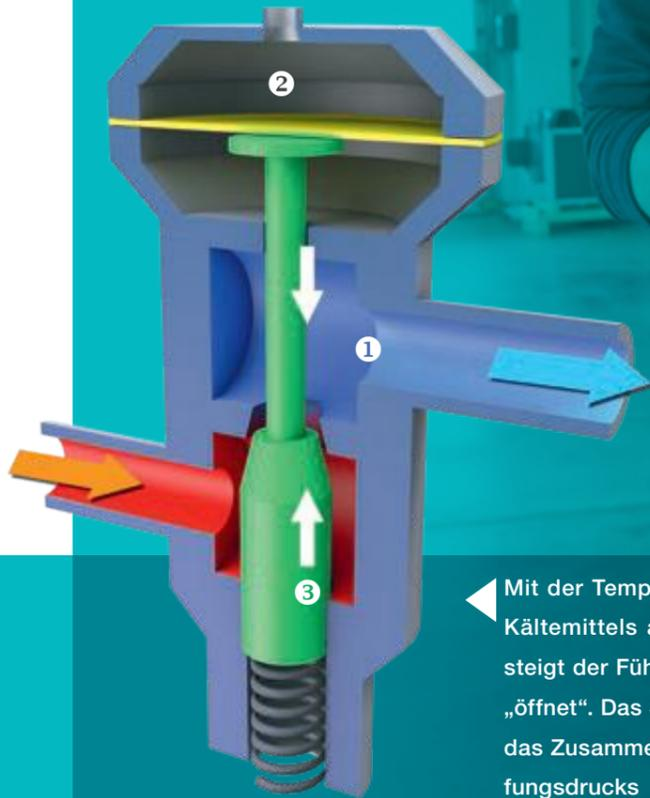
◀ Mit der Temperatur des überhitzten Kältemittels am Verdampferaustritt steigt der Fühlerdruck ②, das Ventil „öffnet“. Das Schließen erfolgt durch das Zusammenwirken des Verdampfungsdrucks ① und dem Druck der Regulierfeder ③.
