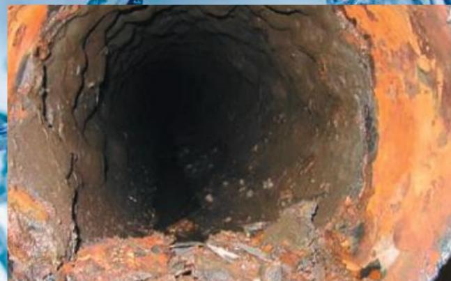
Korrosion im Kühlkreislauf einer unbehandelten Industrieanlage.
